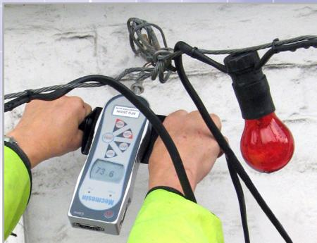
Ensayo de tracción en punto de anclaje
