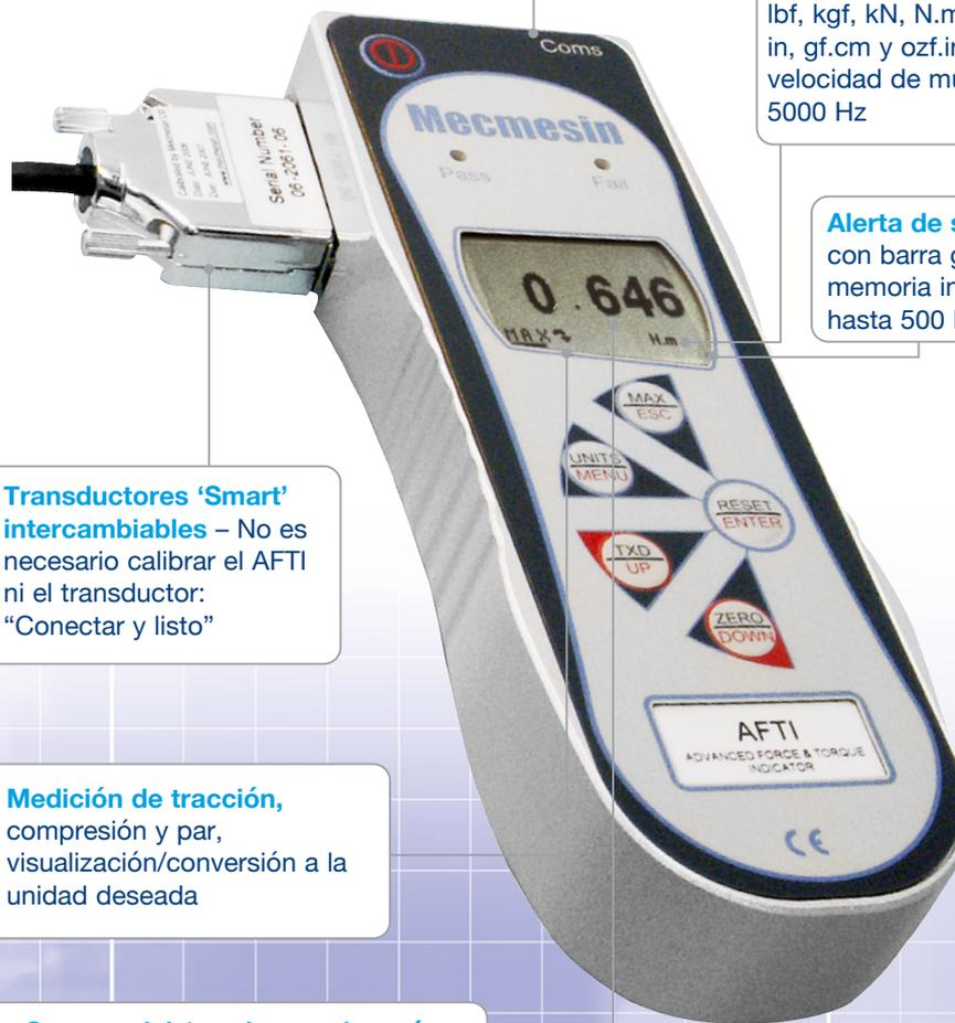
Los sensores "Smart" son ideales para ser montados en los propios utillajes o sistemas de ensayo del cliente, para monitorizar la aplicación de fuerzas o pares. Pueden servir también para verificar la calibración de sus equipos y así constatar que se esté aplicando la carga estipulada.
