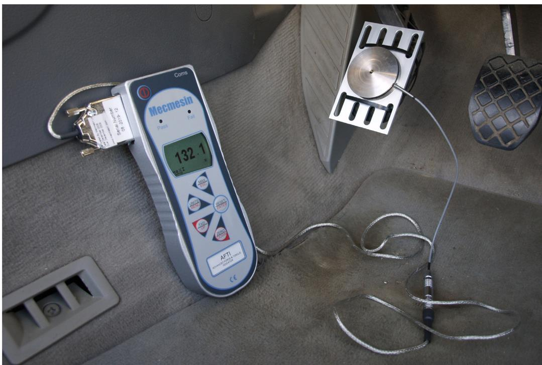
Célula de carga para medición de fuerzas sobre pedal de automóvil
