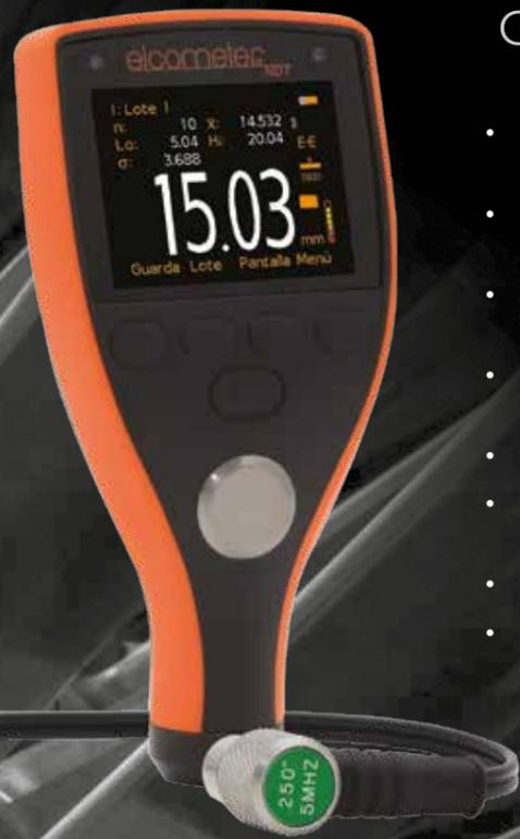
El modelo MTG6, con su gama de opciones de calibración, modos de medición (incluido el modo de exploración de alta velocidad opciones de visualización y registro de datos) resulta idóneo para tomar lecturas de gran variedad de materiales con revestimiento y sin él y descargar datos para realizar análisis adicionales y generar informes.
