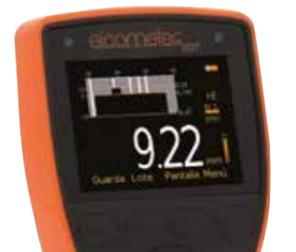
B-Scan bidireccional de corte de transversal, idóneo para análisis de profundidad relativa.
