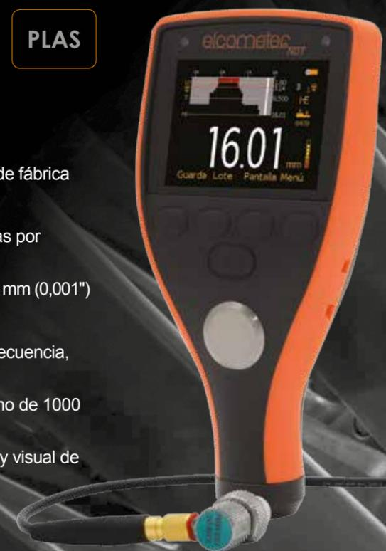
El modelo PTG8 dispone de Modo diferencial; una vez que el usuario ha definido un valor de espesor nominal, el medidor muestra el espesor medido junto con la variación del valor nominal establecido, lo que indica las áreas del material que son más delgadas o más gruesas de lo esperado.
