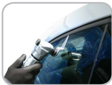
Herramienta indicada para el corte del adhesivo sellador de la lunas
