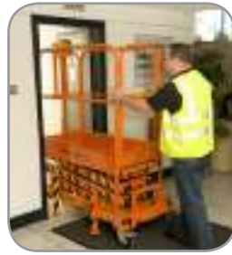
Cerrado pasa por puertas y pasillos
