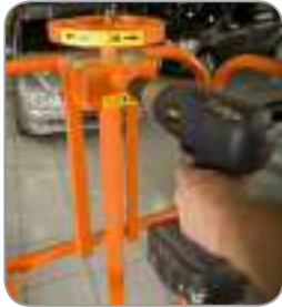
Se puede elevar con ayuda de un taladro eléctrico
