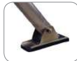
Estabilizadores equipados con zapatas basculantes
