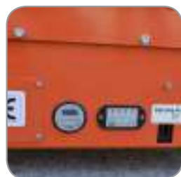
Toma de corriente para la carga de la batería en el bastidor
