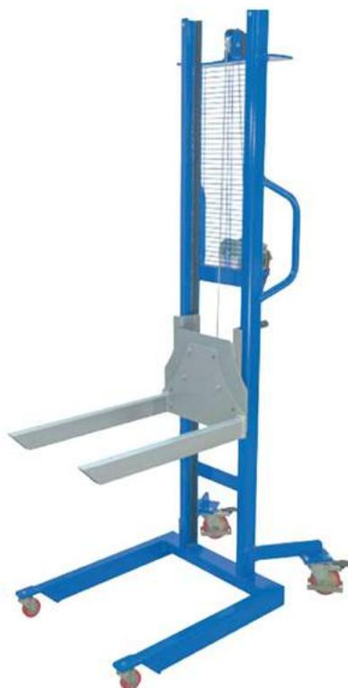
Equipado con manivela para la elevación y 4 ruedas pivotantes, de las cuales dos incorporan freno de pedal.
