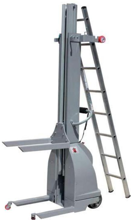
Elevador de materiales con mástil extensible y escalera para operador que se fija al mástil mediante ganchos. Se puede desplazar horizontalmente. Útil para instalación de aire acondicionado, líneas de electricidad, calentadores o para trabajos con pesos en altura.
