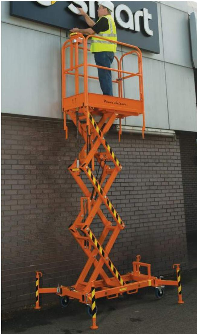
Elevación en pocos segundos mediante taladro eléctrico con efecto multiplicador desde la plataforma.
