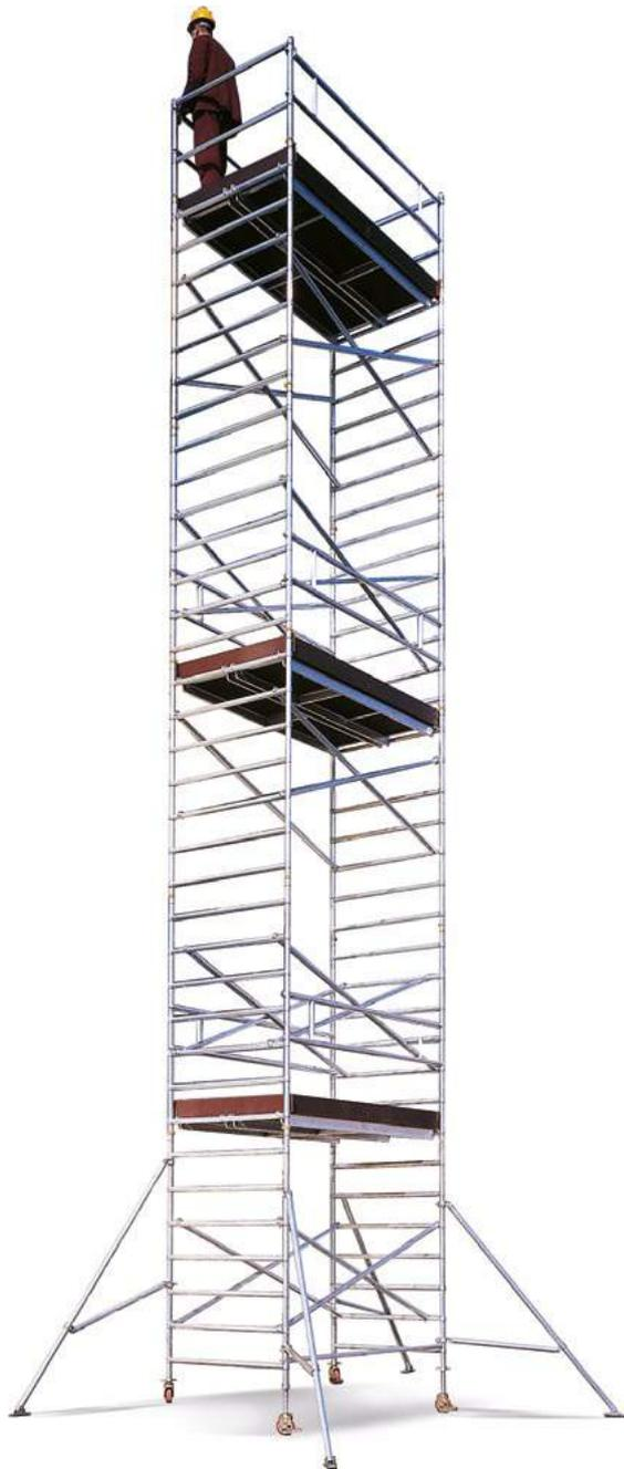
Torre móvil fabricada con aleación ligera de aluminio de alta resistencia, con tubo de  $\varnothing$  50 mm, inoxidable y duradero. Se construye soldando los escalones estriados antideslizantes verticales a los montantes. Es muy rápido de montar siguiendo el detallado Plan de Montaje del fabricante.
