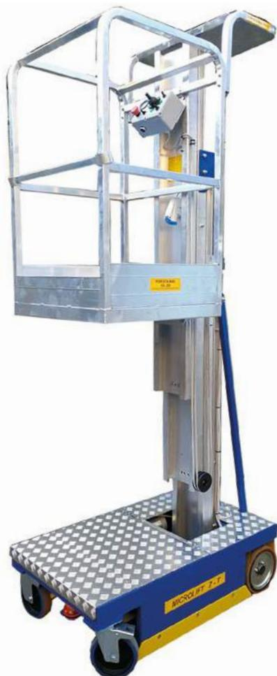
Plataforma aérea autopropulsada compacta: cabe en pequeñas furgonetas. Bastidor de 70 cm de altura pensado para caber debajo de máquinas, líneas de corte o baldas.
