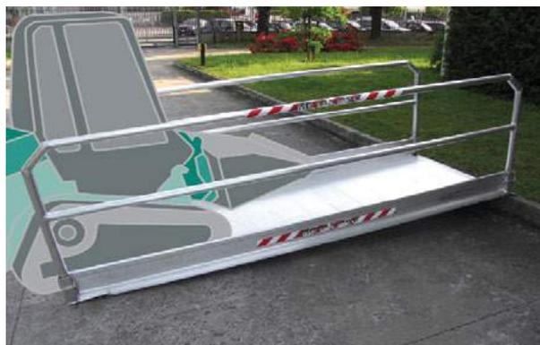
Pasarelas y rampas de máxima capacidad para el paso de personas y vehículos de hasta 4.500 kg. Con superficie antideslizante y barandillas plegables. Pensadas para superar barreras arquitectónicas tales como diferencias de altura debido a obras públicas (rampas) o salvar zanjas (pasarelas). Su diseño especial a ambos lados permite que se ajuste a bordillos y escalones.
