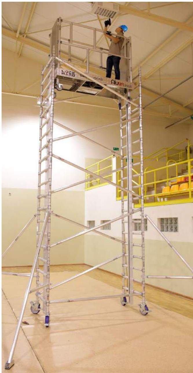
Equipo móvil de trabajo en altura mixto, con las ventajas de una torre móvil y la seguridad de una plataforma elevadora unipersonal. Muy compacto para el transporte. Empuje manual y elevación eléctrica mediante mando desde plataforma.
