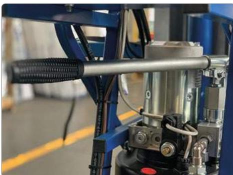
Opcional: bomba de elevación electrohidráulica.
