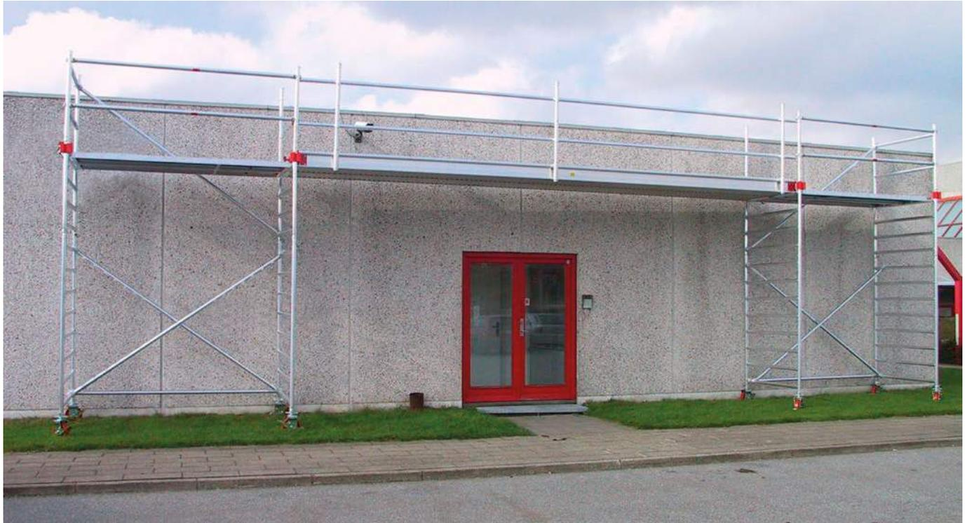
Las pasarelas de aluminio nervado PASSATEMPO se fabrican de 4 a 8 m, comunican dos andamios y deben obligatoriamente anclarse a la pared, proporcionando un pasillo de paso seguro en altura, van provistas de zócalo y de barandillas dobles de protección anticaídas.
