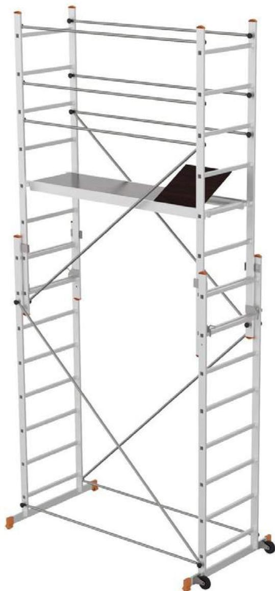
Equipo de trabajo en altura compuesto por 2 escaleras de aluminio transformables y por barras diagonales y horizontales de enganche rápido de acero pintado con polvo epoxi que conforman una estructura rígida y estable. Equipado de una base con 2 ruedas (por ello no es una torre móvil).
