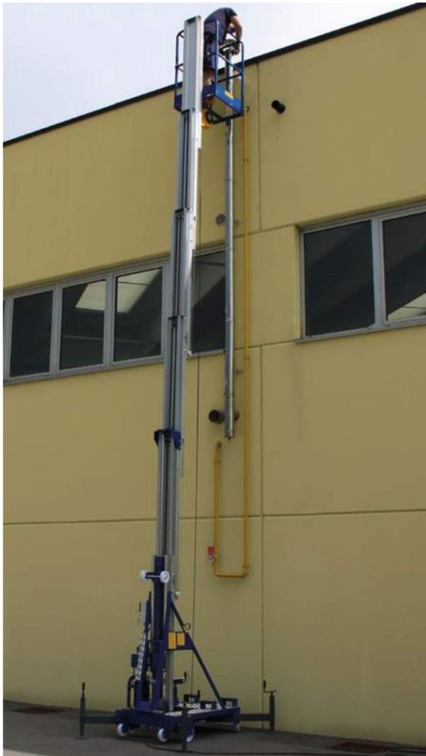
Plataforma aérea de empuje manual y elevación eléctrica. Reducidas dimensiones que le permiten atravesar puertas, pasillos y espacios reducidos. Sistema de inclinación para cargarse con facilidad en vehículos de motor. Capacidad para una sola persona. Homologación para uso interno y externo con estabilizadores estándar.
