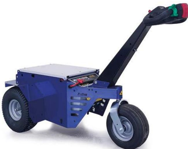
El vehículo eléctrico de arrastre M9 es la solución ideal para eliminar la manipulación manual de cargas.
