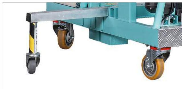
Ruedas con pedal de bloqueo y estabilizadores.
