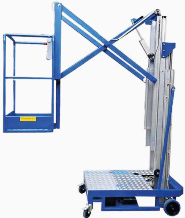
Con columna de elevación con desplazamiento lateral del cesto mediante una tijera, equipada con un brazo hidráulico y cesto voladizo que se desplaza lateralmente a una distancia de hasta 1 m. La elevación y el desplazamiento lateral se controlan desde el cesto.
