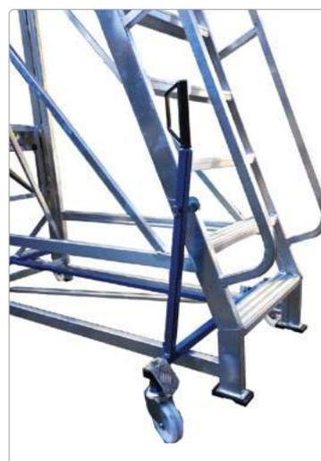
**SICURBLOCK.** Freno de acción rápida: palanca de freno que levanta las ruedas del suelo al ser activada, evitando que la escalera pueda ponerse en movimiento.
