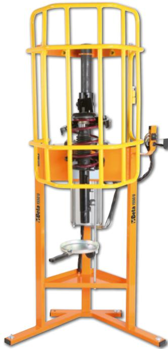
Estribo a la izquierda, para compresor neumático de muelles de amortiguación 1555U
